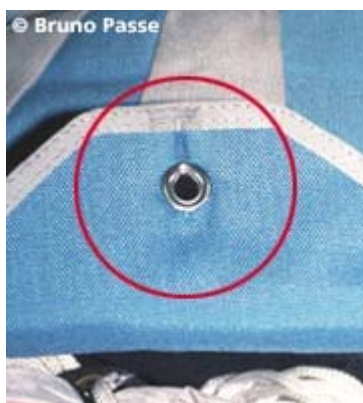
Oeillet de fermeture du sac de secours déformé : Soit le plieur n'était pas compétent, soit le volume de la voile ou le réglage du loop de fermeture n'étaient pas compatibles. Usure anormale.
