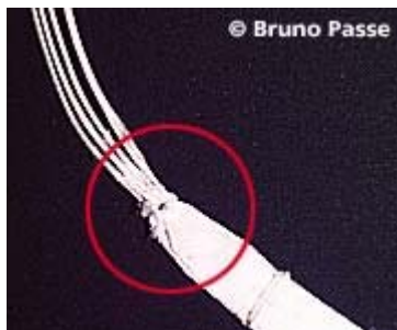
Connexion souple usée entre la voile principale et les élévateurs. Usure normale si la voile a beaucoup de sauts, anormale si la voile a peu de sauts (l'utilisateur ne rétractait vraisemblablement pas son glisseur et il le laissait flapper au niveau de la connexion, d'où l'usure).
