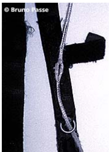
Élévateur et commande de manoeuvre "très fatigués"... Cela signifie que le matériel a beaucoup sauté. Usure normale.
