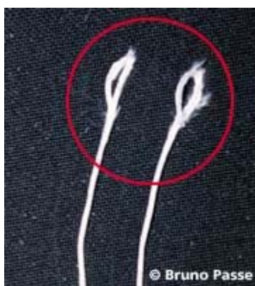
Loop de fermeture de secours à changer : peu onéreux mais peut s'avérer vital. Usure normale, mais le loop aurait dû être changé lors du dernier repliage.
