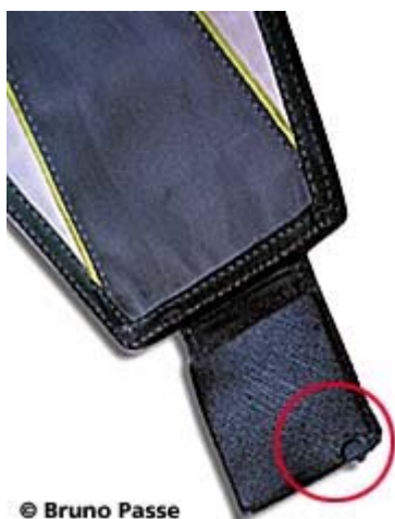
Patelette de fermeture du sac principal usée : par frottement, le coin de la plaque de plastique qui rigidifie cette pièce peut entamer le tissu. Usure normale.
