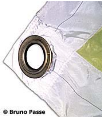
Oeillet de glisseur déformé par les chocs à l'ouverture : Cela signifie certainement que la voile s'ouvre violemment. Usure anormale.
